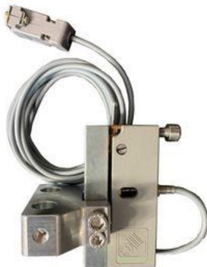
Рисунок. Механический датчик этикетки ДМ-01 (Производство ООО «Арни-Групп») Диапазон толщины этикетки регулируется при помощи механического регулятора. Светодиод, расположенный в центре датчика, сигнализирует о его срабатывании.
